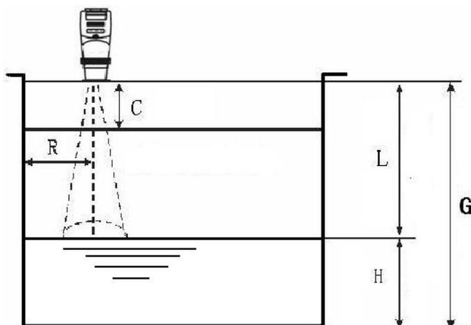
**设置 20mA 电流输出对应液位值(02)** 实际液位值不能超过此值，否则输出电流会大于 20mA 而出错，该参数出厂设置为仪表的最大量程值。
